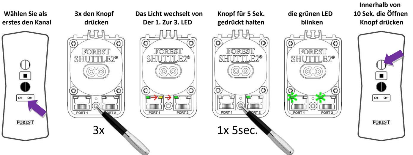
Jetzt können Sie die Endpositionen einstellen, indem Sie per Hand den Überzugwagen anschieben (Touch) bis der Vorhang geschlossen ist. Jetzt schieben Sie den Überzugwagen wieder auf, jetzt blinkt die gelbe LED, Sie haben 10 Sekunden Zeit die Parkposition des Vorhangs zu verändern. Danach erlischt die gelbe LED, und die Endpositionen sind gespeichert.
